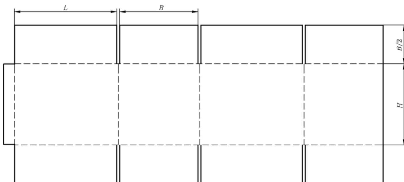
图 A.1 半叠盖式包装箱结构
