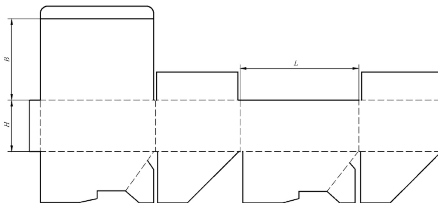
图 A.2 互插盖式包装箱结构
