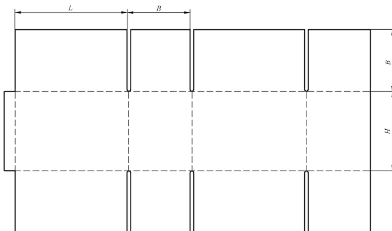
图 A.4 全叠盖式包装箱结构
