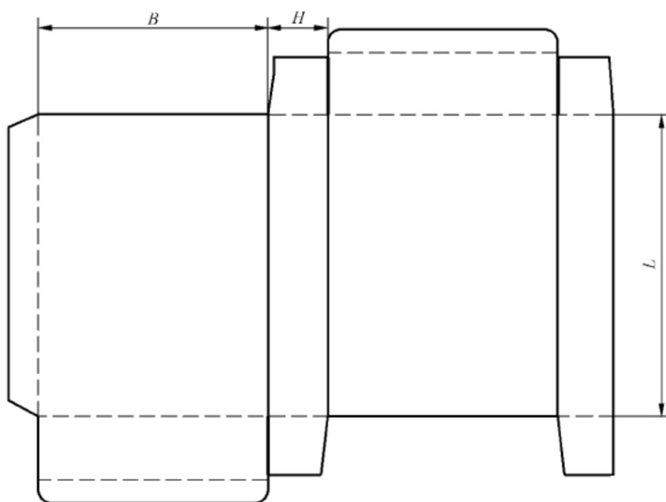
图 A.3 插入式包装箱结构
